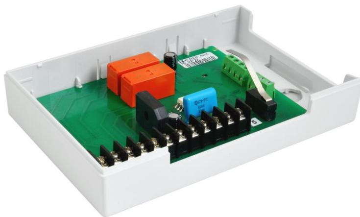
Адресный исполнительный модуль для коммутации нагрузки в цепях переменного или постоянного тока
