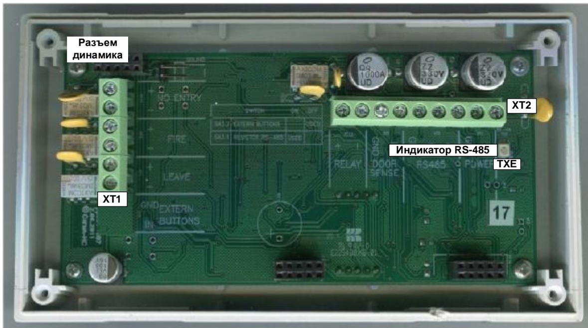
**Рис. 2 Расположение элементов на плате ППО**
