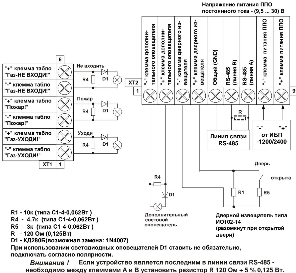
**Рис. 5 Подключение ППО**
