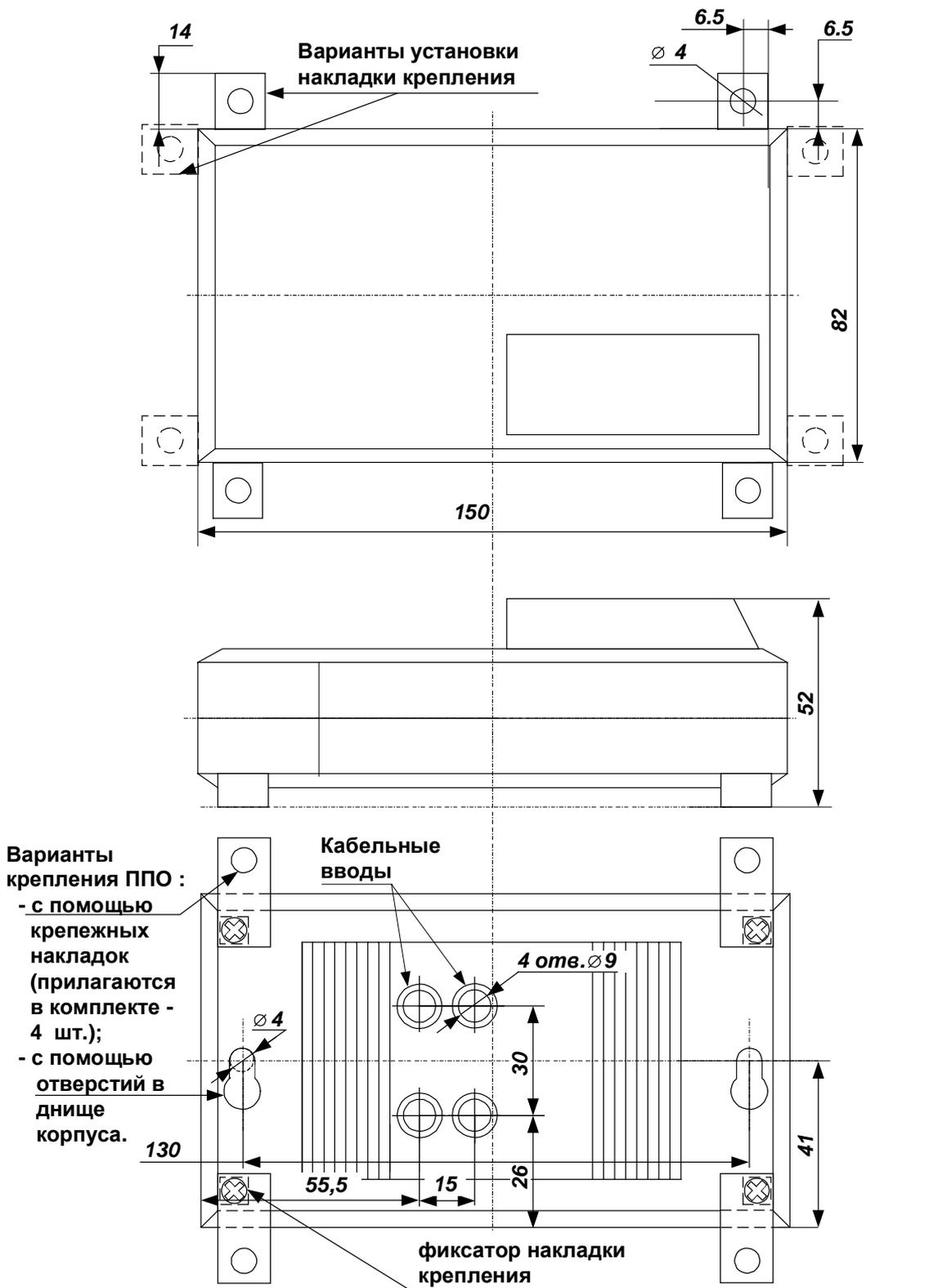
Для закрепления накладок - отвернуть 4 самореза на днище корпуса ППО; установить накладку на днище корпуса, зафиксировав фиксатор накладки в выемке днища корпуса ППО; завернуть саморезы из комплекта.
