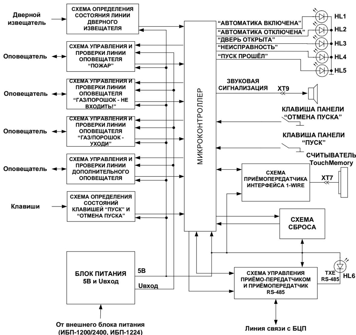
Рис. 3 Структурная блок-схема ППО
