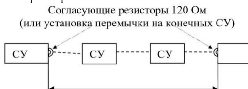
Рисунок 5 – Подключение сетевых устройств на линию RS-485
