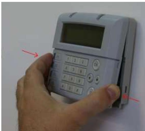
1. Для снятия крышки корпуса следует сжать ее с боков и отклонить вверх.
