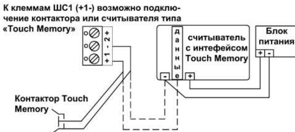
Рисунок 15 – Подключение контактора (считывателя – пунктиром) «Touch Memory»
