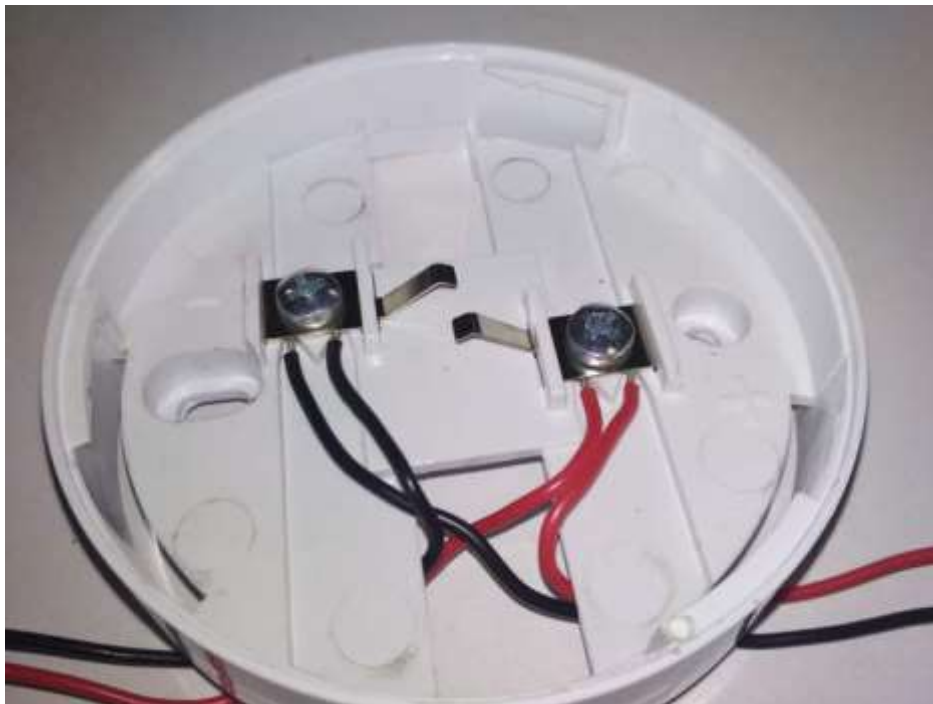
Рис. 6 Присоединение проводов к базе АЗДПИ
