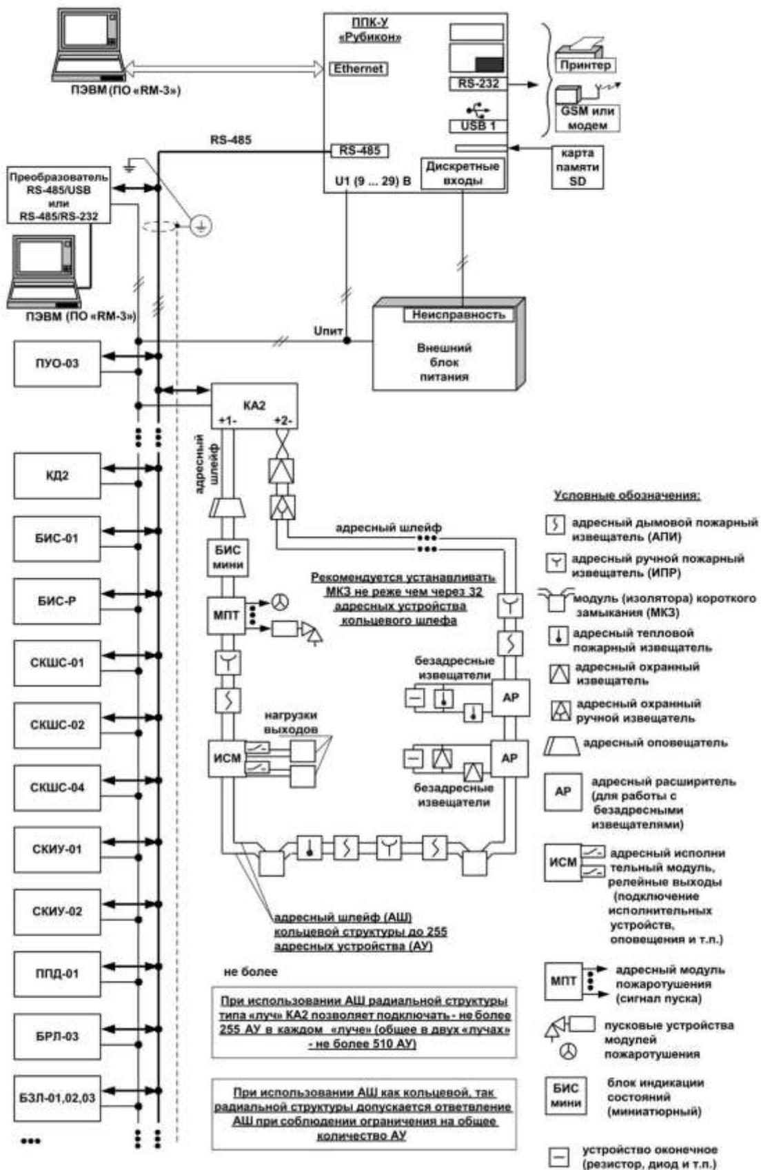
Рисунок 1 – Использование (подключение) ППК-У в составе АСБ «Рубикон»
