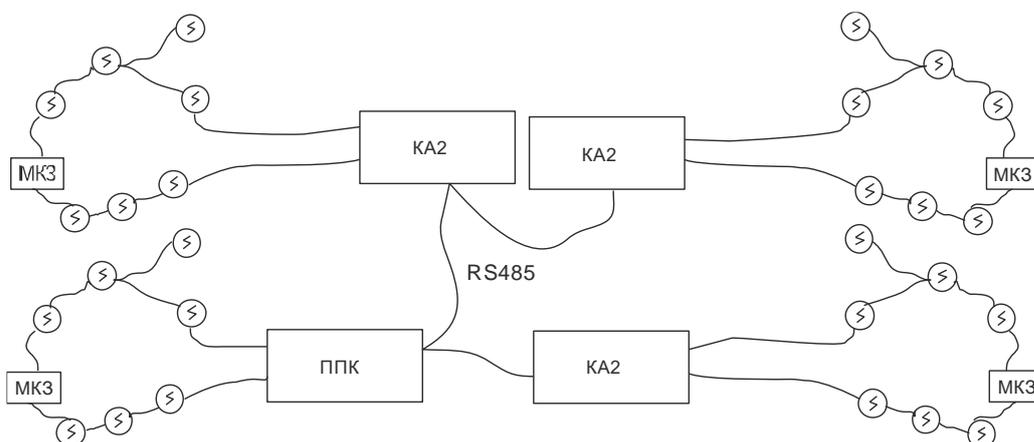
**Рисунок 6 – Подключение адресных устройств при помощи КА2**
