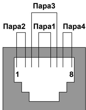
Рисунок 7 – Подключение ППК и ПЭВМ (Ethernet)
