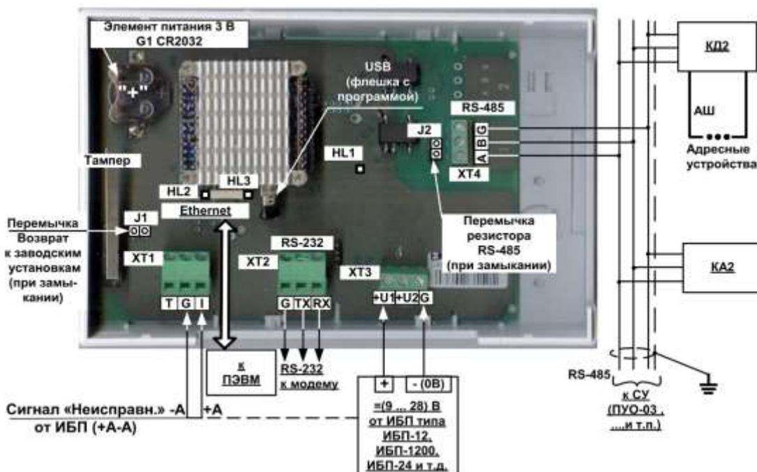
Рисунок 3 – ППКУ, подключение
