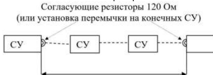
**Рисунок 5 – Подключение сетевых устройств на линию RS-485**
