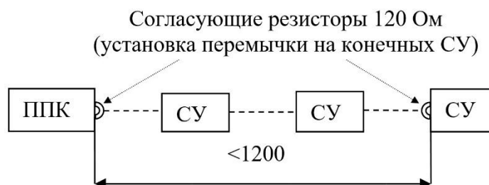
Рисунок 4 – Подключение сетевых устройств к линии RS-485
