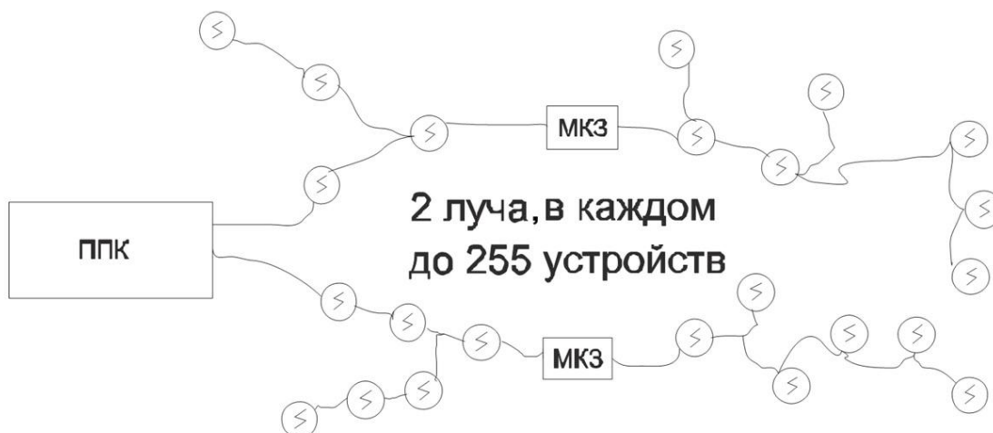
Рисунок 6 – Подключение адресного шлейфа в режиме «два луча»
