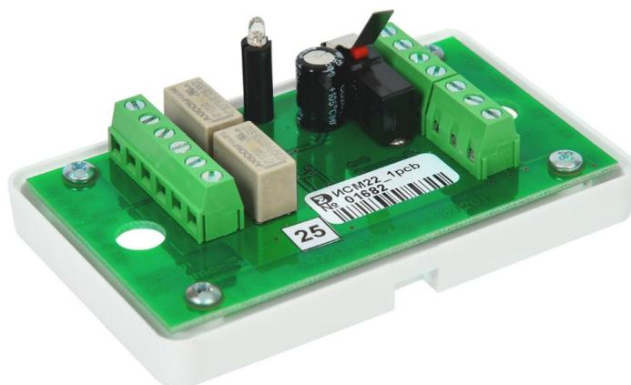
Адресный исполнительный модуль
