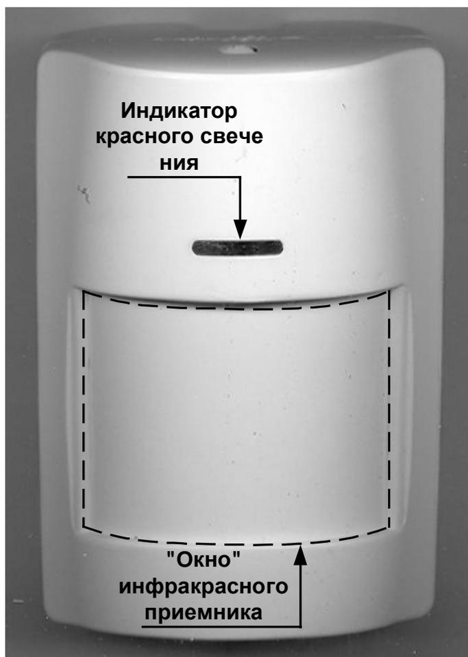
**Внимание.** При монтаже АОПИ должен быть направлен на охраняемую зону. Не допускается наличие каких-либо преград в направлении приемника.
