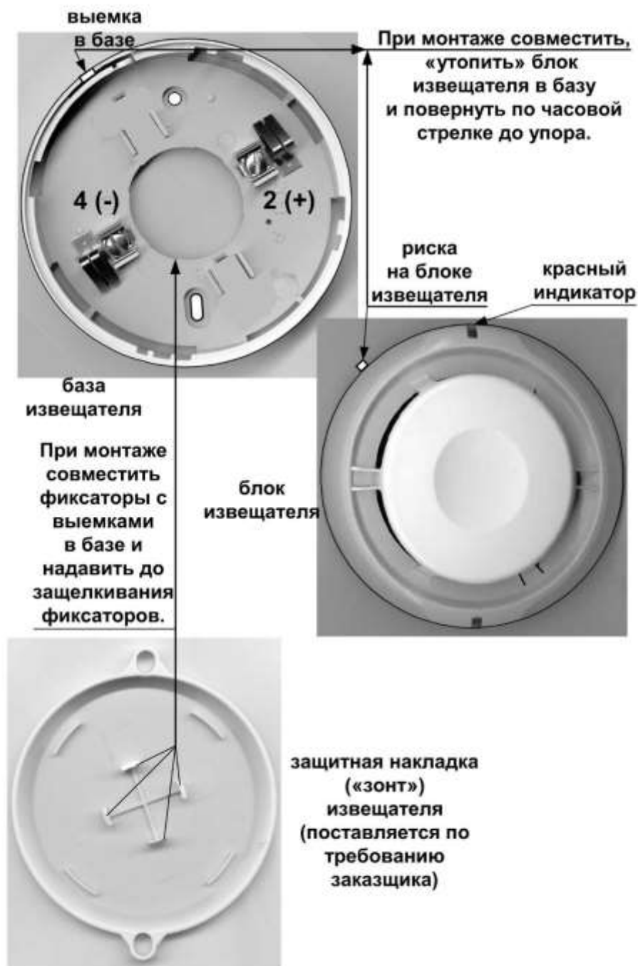
Рисунок 2 – А2ДПИ. База, блок извещателя и накладка «Зонт»
