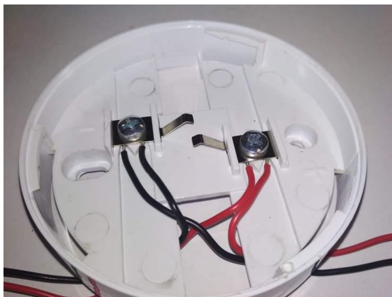
Рисунок 6 – Присоединение проводов к базе АЗДПИ
