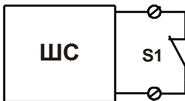
Рисунок-схема 5 – Подключение НЗ контактов без контроля целостности линии связи
