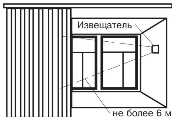
Рисунок 5 – Установка извещателя между стеклом и занавесями (жалюзи)
