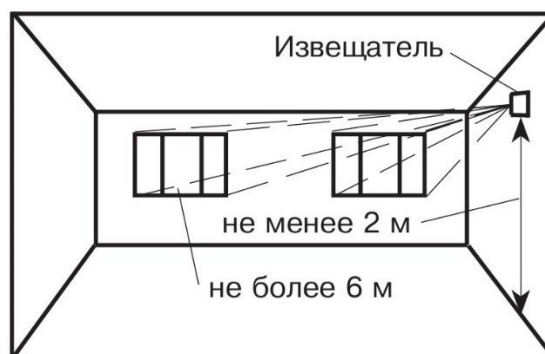
Рисунок 2 – Установка извещателя на боковой стене
