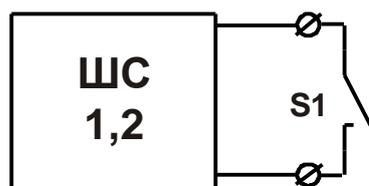
Рисунок-схема 6 – Подключение извещателя (датчика) с НР контактами без контроля целостности линии связи.
