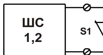
Рисунок-схема 5 – Подключение извещателя (датчика) с НЗ контактами без контроля целостности линии связи.
