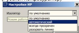
Настройки параметров ИР в Конфигураторе (и в консоли) сводятся к выбору режима работы изолятора. Подробнее – см. описание [МКЗ](#).
