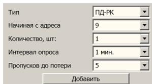
Последние два параметра аналогичны общим настройкам «Период опроса» и «Попыток до потери связи», только относятся к добавляемому устройству. В дальнейшем они могут быть изменены.
