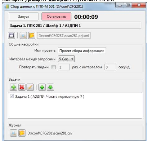
Параметры сканирования задаются в **проекте** сканирования. Он может быть сохранен и впоследствии загружен в Конфигуратор.
