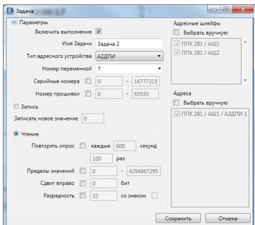
В окне «Задача» задаются условия для каждой задачи индивидуально. Здесь можно задать Имя Задачи, которое вместе с пояснением отображается в списке задач окна «Сбор данных». Для задачи из списка выбирается Тип адресного устройства и Номер переменной. Дополнительно можно уточнить интервал серийных номеров выбранного типа устройств и номер их прошивки.
