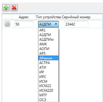
После настройки адресного шлейфа можно записывать его в прибор. Для этого выберите команду «Записать в прибор» из контекстного меню соответствующего шлейфа. Процесс синхронизации запишет короткие адреса и сделанные настройки непосредственно в сами адресные устройства. Это может занять некоторое время.
