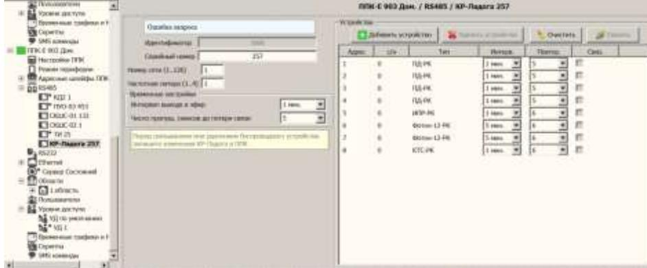
Добавлять, удалять устройства в Конфигураторе можно автономно, без установленной связи с ППК.
