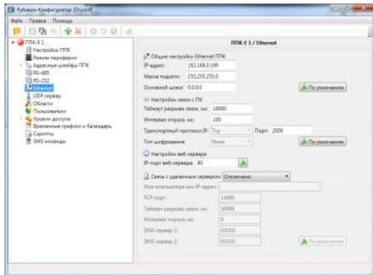
**Внимание!** После записи в прибор узла Ethernet возможно кратковременное пропадание связи с прибором. Кроме того, если записываемые настройки соединения не соответствуют конфигурации сети (прибор становится вне сети компьютера), связь не восстановится до тех пор, пока настройки компьютера не будут приведены в соответствие с ними.
