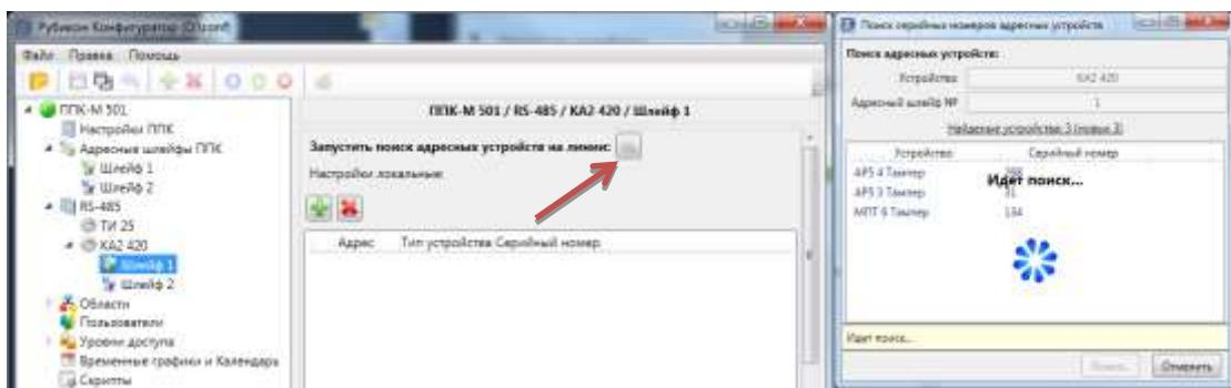
Возможно также создание конфигурации без непосредственной связи с контроллером. Для этого нажмите кнопку добавления нового адресного устройства (зеленый плюс). Затем выберите нужный тип устройства, задайте его серийный номер и адрес.
