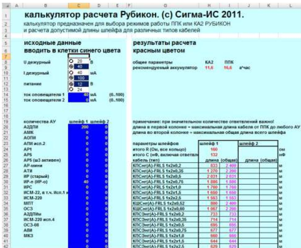
Здесь задаются исходные данные для расчетов: **напряжение** и **ток** в адресном шлейфе в дежурном режиме, **напряжение питания** ППК (КА2), **ток оповещателя 1 и 2** на ППК (КА2). Также надо указать количество адресных устройств каждого типа на шлейфах 1 и 2 (в случае использования кольцевого шлейфа всегда рассматривается только шлейф 1).
